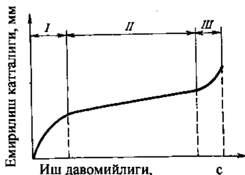
3.4-rasm. Yemirilish kattaligining birikmalar ishlash davomiyligiga bog'liqligi: I-ishqalanib moslashish bosqichi; II-normal ishlash bosqichi; III-o'sib boruvchi yemirilish bosqichi.
